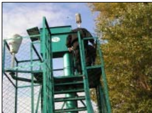
пункт за измерване на характеристиките на подземните води
