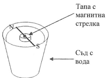
Фиг. 7. Модел на компас от тапа и магнитна стрелка.
